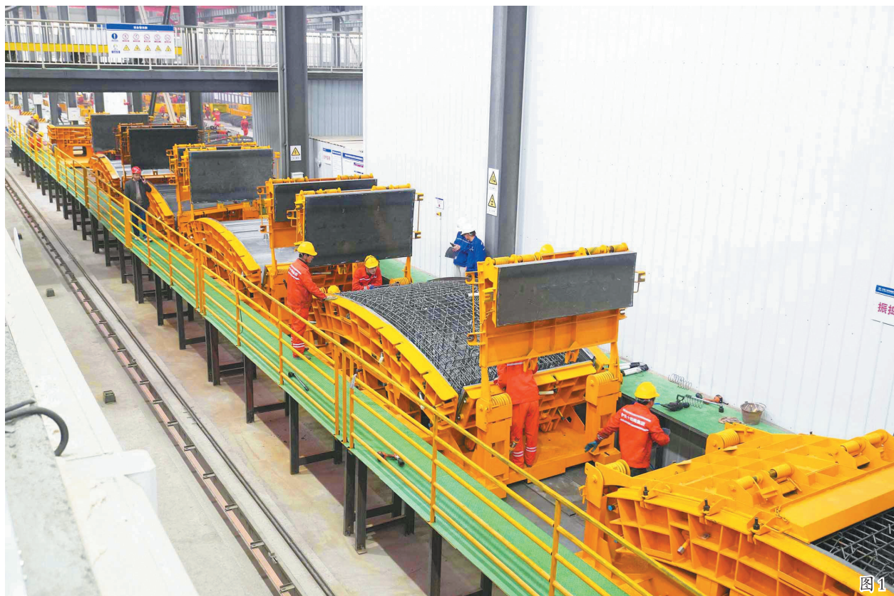
图1图2 3月1日,在蔡家智慧新城中铁十四局重黔铁路站前2标管片场,工人在生产重庆长江隧道盾构管片。
