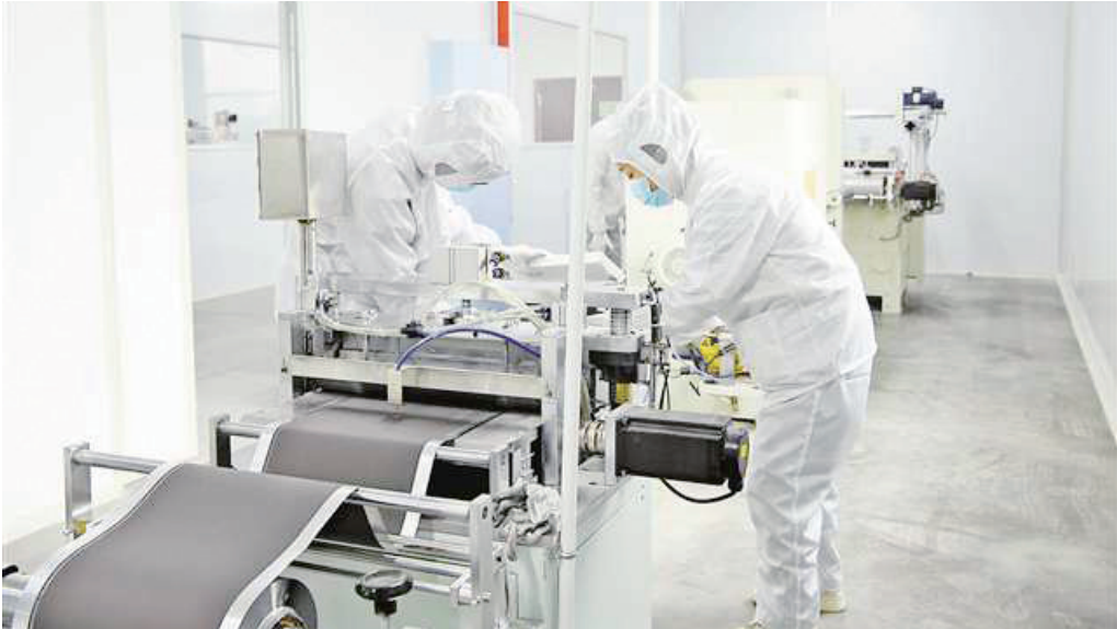
1月28日，潼南尼古拉科技产业研究院，第一块大容量高能量密度纳米固态钠离子电池中试产品下线。 重庆日报记者 周雨 摄/视觉重庆
