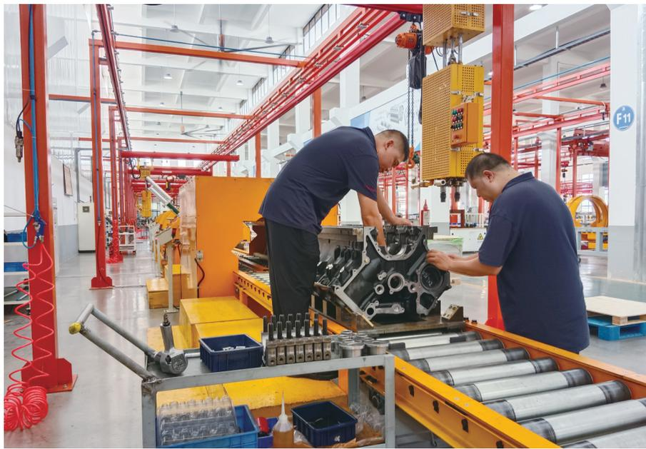
图为公司员工为发动机安装油道防泄漏装置。
