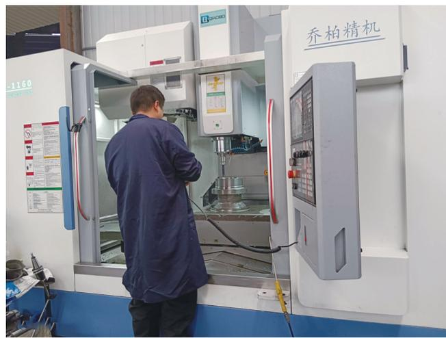
顺光机械厂员工正在加工中心精心打磨齿轮。
