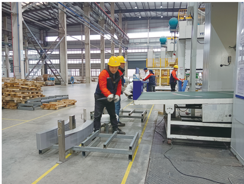
工人正在码放下线的冲压件。
