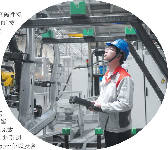
▲沈音宏操作搬运机器人抓取坦克300车型右侧围总成件。
