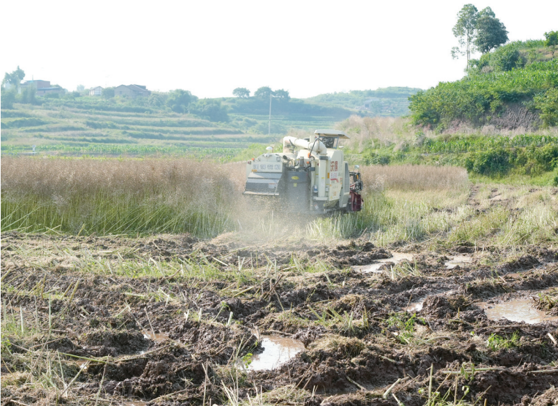
搭载了单模北斗导航应用的无人驾驶收割机收割油菜。
